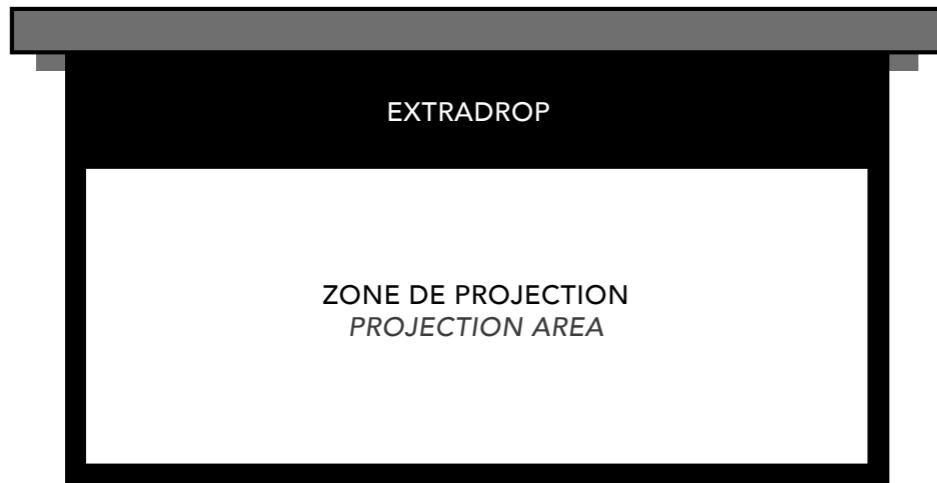
L'extradrop est la zone noire de la toile d'un écran Lumene située au-dessus de la zone de projection. La hauteur de cette bande noire peut être ajustée afin de positionner verticalement la zone de projection.
